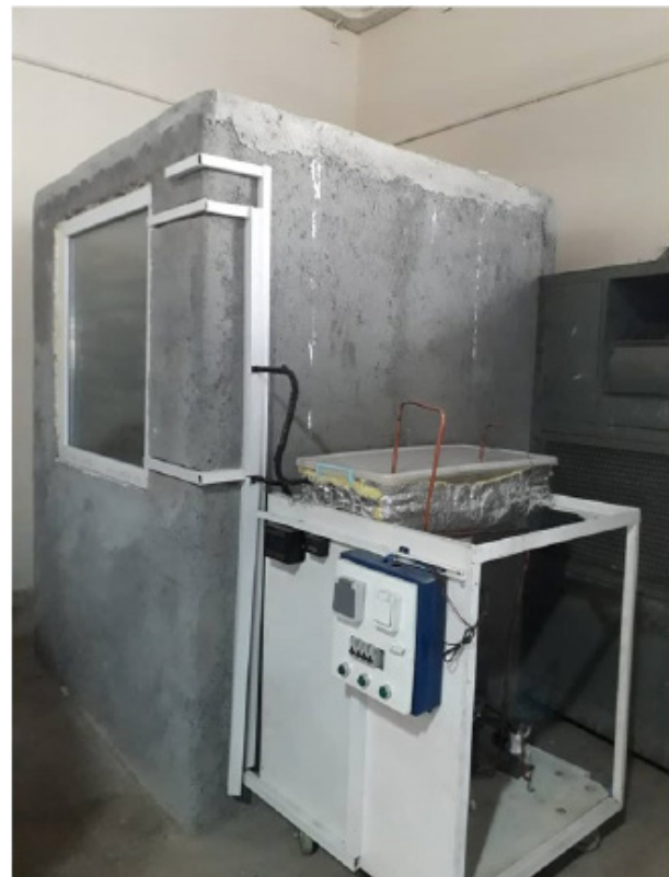
شکل ۴: نمایشی از اتاق و سیستم سرمایش استفاده شده
