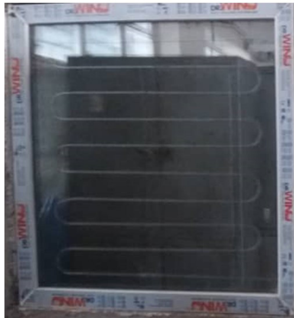
شکل ۳: پنجره با کویل شیشه‌ای استفاده شده در این پژوهش
