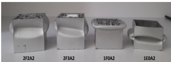
شکل ۲: تغییر شکل نهایی و لهیدگی نمونه‌های موردنظر تحت آزمون ضربه محوری.
