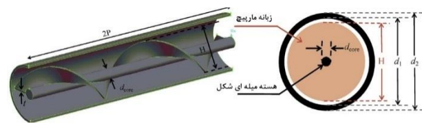
شکل ۵: شماتیک لوله جاذب با توربولاتور مارپیچ حلزونی [۶۴]
