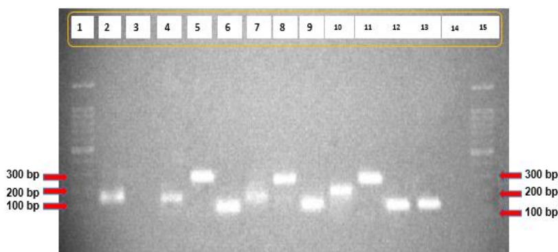
شکل ۳- الکتروفورز ژل آگارز جوانه‌های ذرت. چاهک‌ها به ترتیب از چپ به راست؛ ۱- نشانگر اندازه. ۲- کنترل مثبت راه‌انداز 35S. ۳- کنترل منفی. ۴- راه‌انداز 35S در جوانه ذرت وارداتی از بندر امام. ۵- ژن اینورتاز در جوانه ذرت وارداتی از بندر امام. ۶- خاتمه‌دهنده nos در جوانه ذرت وارداتی از بندر امام. ۷- راه‌انداز 35S در جوانه ذرت دزفول. ۸- ژن اینورتاز در جوانه ذرت دزفول. ۹- خاتمه‌دهنده nos در جوانه ذرت دزفول. ۱۰- راه‌انداز 35S در جوانه ذرت خوزستان. ۱۱- ژن اینورتاز در جوانه ذرت خوزستان. ۱۲- خاتمه‌دهنده nos در جوانه ذرت خوزستان. ۱۳- کنترل مثبت خاتمه دهنده nos. ۱۴- کنترل منفی. ۱۵- نشانگر اندازه.
