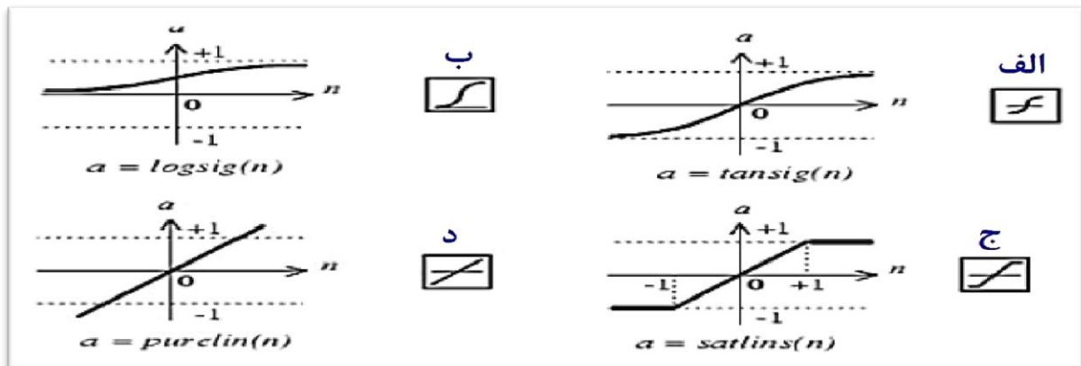
شکل ۷. نمودار توابع فعالیت در شبکه‌های عصبی مصنوعی (الف- تابع تان‌سیگموئید، ب- تابع لوگ‌سیگموئید، ج- تابع اشباع خطی، د- تابع خطی)
