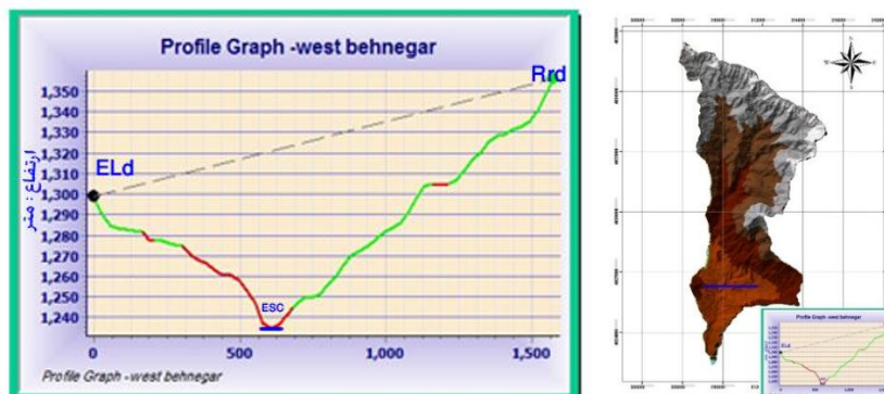
شکل ۱۰. نحوه محاسبه پارامترهای شاخص نسبت پهنای کف دره به عمق دره (Vf). (منبع: نگارندگان)
