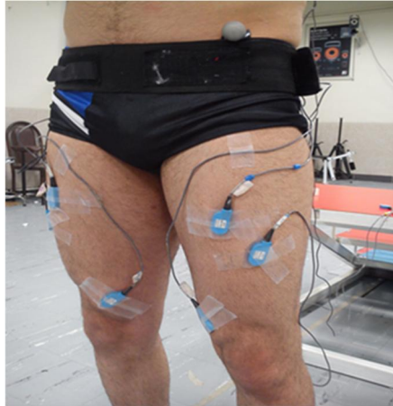
شکل ۱: موقعیت قرار دادن الکترودها روی عضلات منتخب
