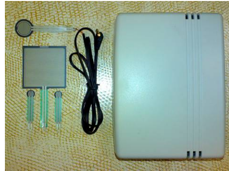
تصویر ۱- بریس تایمر و سنسورهای مختلف آن
