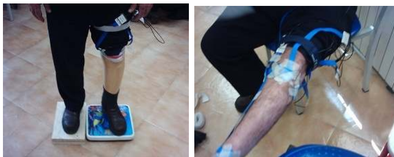
شکل ۱: الف - قرار دادن حسگرهای سیستم پلاینس روی پوست استامپ-ب- اندازه گیری استاتیک، با اعمال نیمی از وزن بدن به اندام پروتزی.
