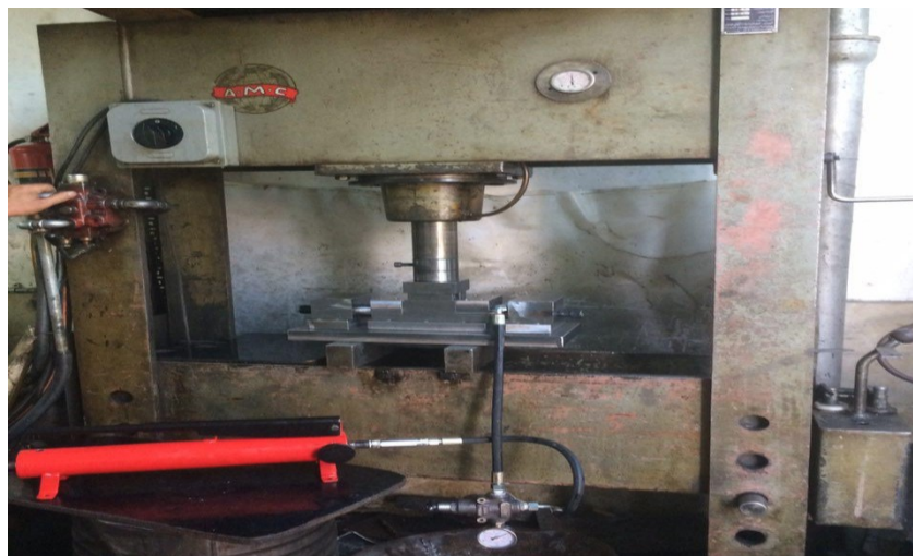
شکل ۱۱ نمایشی از پرس و قالب در آزمایش تجربی
