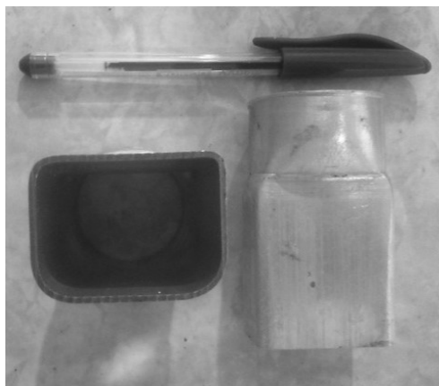
شکل ۱۶ سطح مقطع میانی قطعه شکل داده شده
