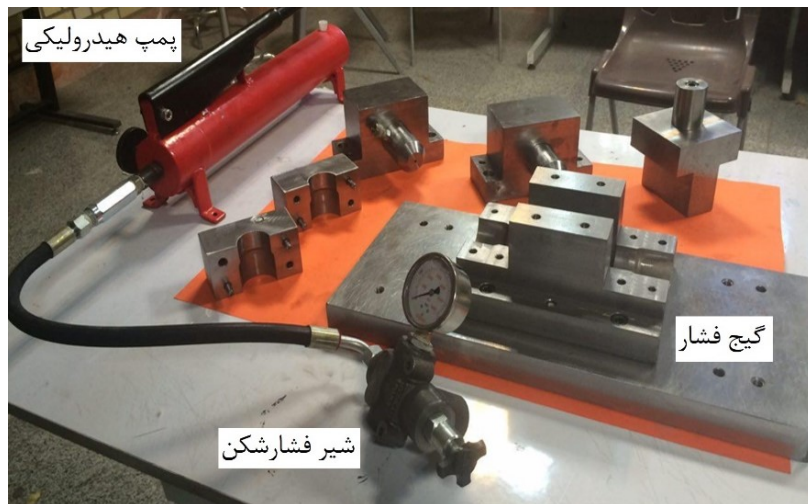
شکل ۷ اجزای قالب هیدروفرمینگ لوله
