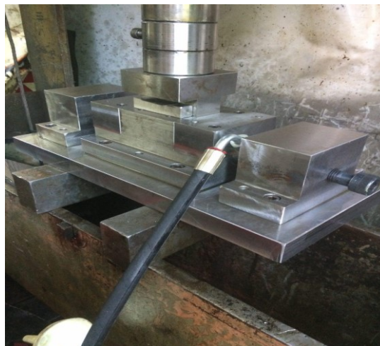
شکل ۱۰ اتصال شلنگ پمپ دستی به سنبه محوری
