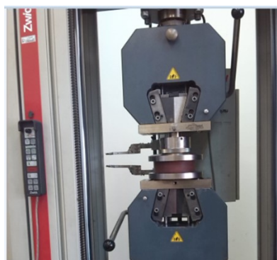
شکل ۱ آزمون فشار برای نمونه لاستیکی
