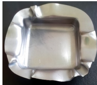
شکل ۱۲ نمونه فولادی شکل داده شده با قالب ماتریس لاستیکی و دارای حلقه واسطه
