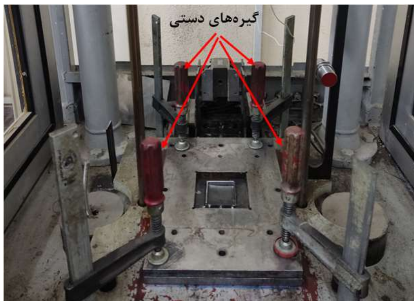
شکل ۱۶ فیکسچر و گیره‌های دستی محکم‌کننده آن
