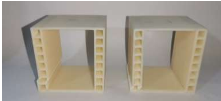
شکل ۲۵ نمونه‌های 1HQ8 پس از انجام تست ضربه و ایجاد تغییر شکل در آنها
