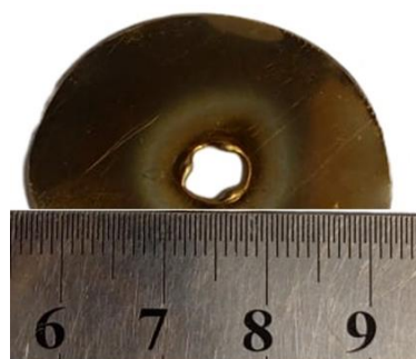
شکل ۱۴. نتیجه تجربی تبخیر با تفنگ الکترونی جدید.
