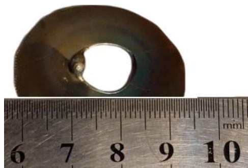
شکل ۳. نتیجه تجربی تبخیر با تفنگ الکترونی موجود.
