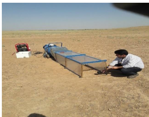
شکل ۴: اندازه‌گیری سرعت آستانه‌ی فرسایش بادی دستگاه تونل باد
