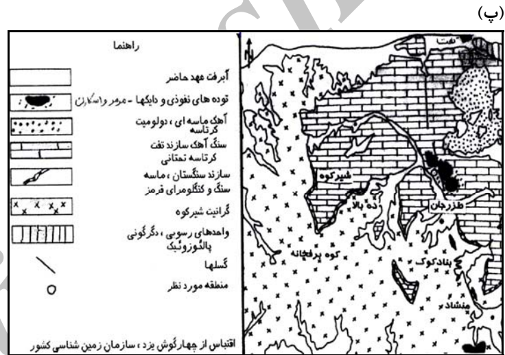
شکل ۱- الف) جایگاه اسکارن‌های مورد مطالعه در نوار ماگماتیسم سنوزویک ایران مرکزی (F= فشارک و S= شیرکوه)، ب) نقشه زمین‌شناسی اسکارن فشارک اصفهان (برگرفته از نوربهبشت، ۱۳۷۰)، پ) نقشه زمین‌شناسی اسکارن شیرکوه یزد (برگرفته از مکی زاده، ۱۳۸۷ با تغییرات) (مقیاس ۱:۲۵۰۰۰۰)
