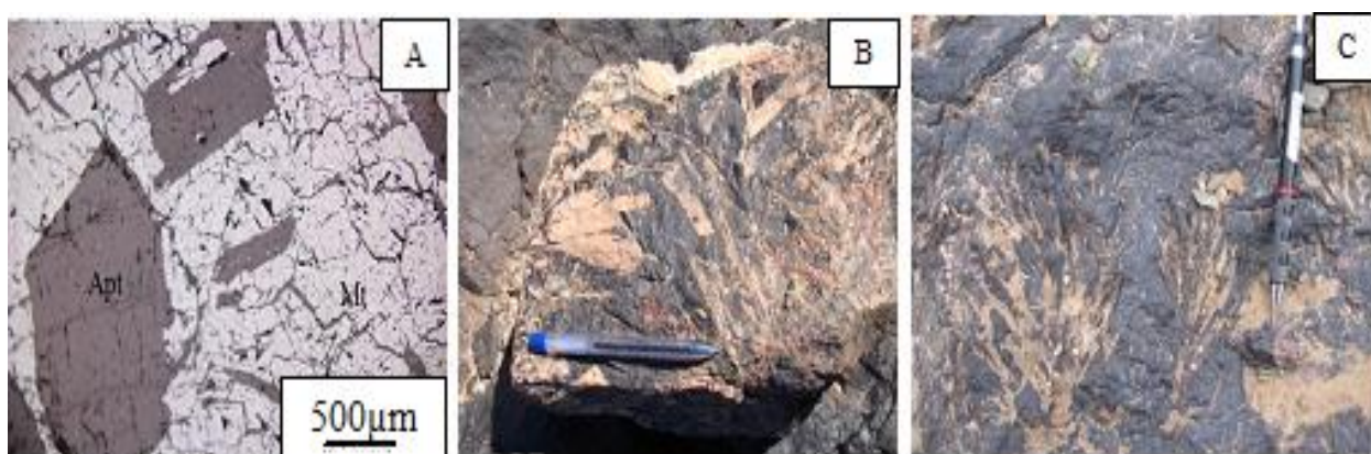
شکل ۷- A) بلورهای بی‌پیرامیدال آپاتیت در متن کانسنگ مگنتیت در نور انعکاسی؛ B) بلورهای تیغه‌ای آپاتیت در زمینه‌ای از مگنتیت که بافت اسکتی را شکل داده است؛ C) بافت دسته جارویی آپاتیت در مگنتیت در کانسار گزستان.
