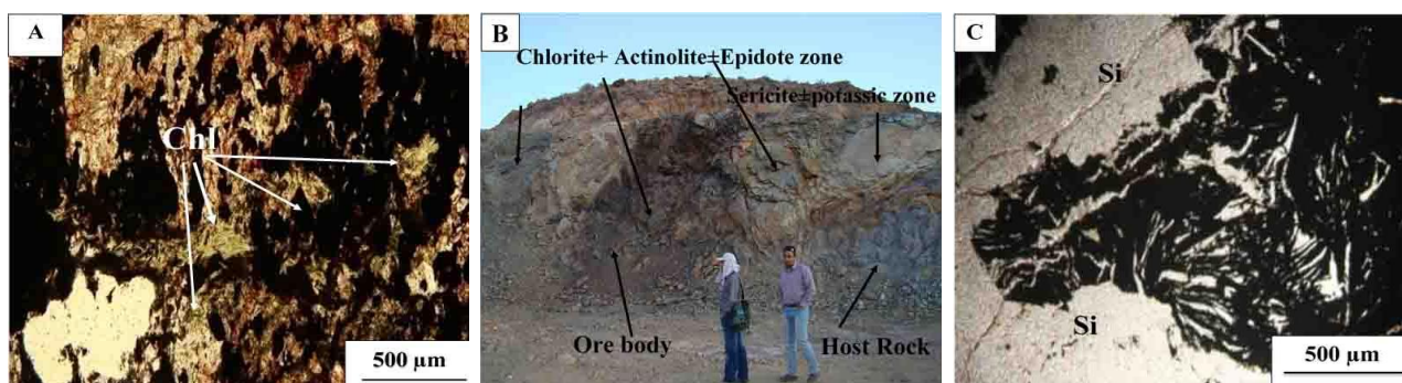
شکل ۱۱- (A) همراهی کلریت و مگنتیت؛ (B) همجواری پهنه سریسیت و کلریتی در شرق محدوده؛ (C) بافت سیمپلکتیتی (تداخل مگنتیت و سیلیس) در کانسنگ مگنتیتی (PPL) کانسار گزستان.
