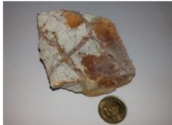
شکل ۴- رگه - رگچه‌ها و کانی‌زایی استوکورکی سیلیسی در منطقه ماربین (شمال شرق اصفهان).
