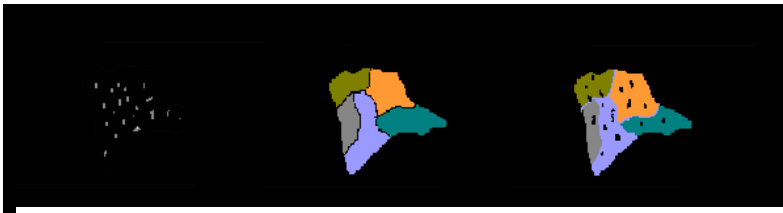
تراکم ریزش‌های سنگی بر روی واحدهای لیتولوژیکی = واحدهای لیتولوژیکی / پراکندگی ریزش‌ها
