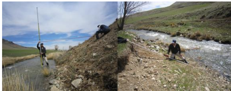
شکل ۳: تصویر کرانه رودخانه گلالی و نحوه اندازه گیری پروفیل کرانه رودخانه.
