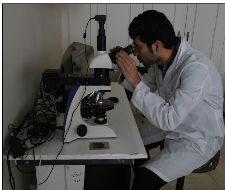
شکل ۵. مطالعه مقاطع نازک خاک زیر میکروسکوپ پلاریزان
