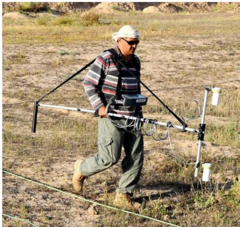
شکل ۶. استفاده از دستگاه گرادیمتر یخار سزیم رییدوم در بررسی ژئوفیزیک گورستان تاج‌امیر
