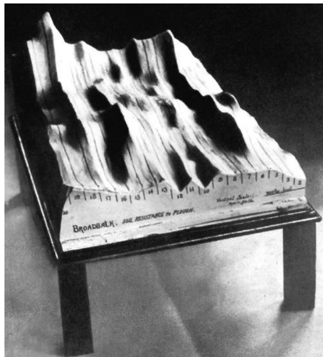
شکل ۲- مدل ۳ بعدی تغییرات مقاومت مکانیکی خاک (از Haines و Keen، ۱۹۲۵b)
