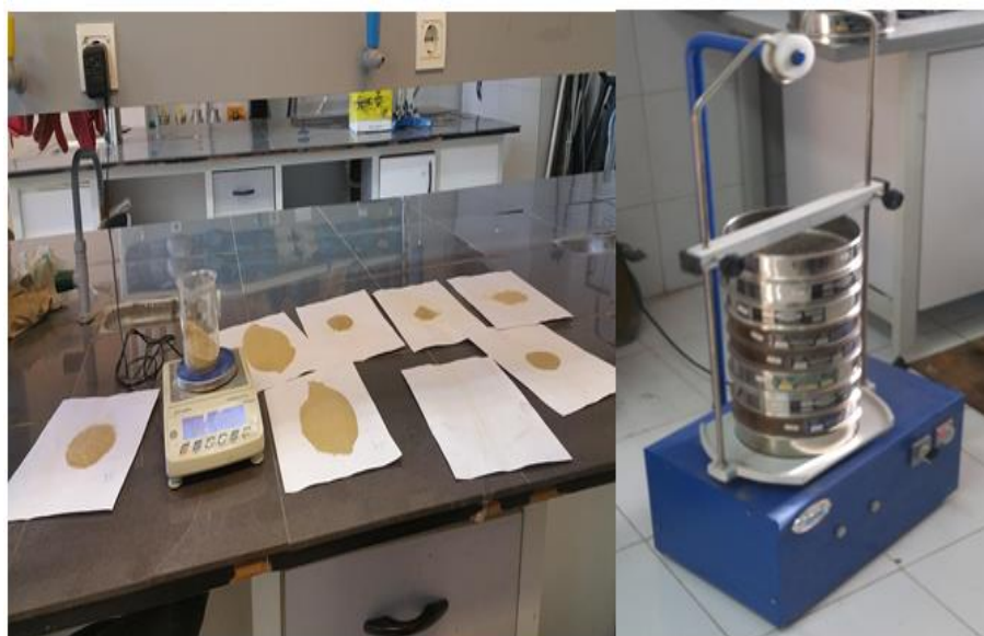
شکل ۵: نمایی از اندازه‌گیری وزن ذرات نمونه‌های خاک برداشتی براساس روش الک خشک
