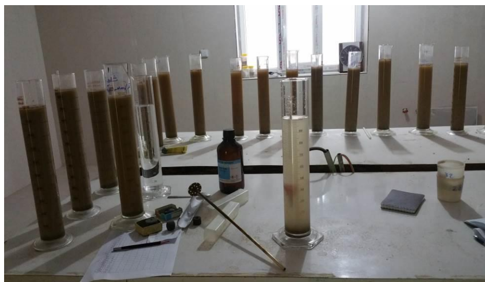
شکل ۴: نمایی از آزمایش هیدرومتری نمونه‌های خاک برداشت شده از کاربری‌های مورد مطالعه
