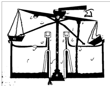
شکل (۶) - تصویر دستگاه نی‌زنی دائمی جزری با سیستم کنترل کفه (دستگاه نهم از نوع چهارم)
