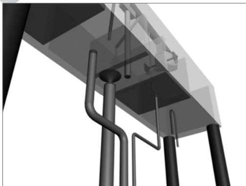
شکل (۱۹) - لوله‌کشی زیر حوضچه سیستم کنترل فواره چهارم تقی‌الدین
