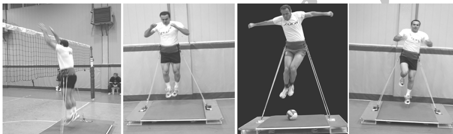
تصویر ۱. دستگاه تمرین الاستیک (توانی) محقق ساخته
