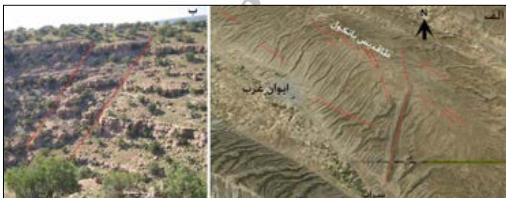
شکل ۹: (الف): تصویر ماهواره‌ای کوپک برد طاق‌دیس بانکول و محل شکستگی‌های تکتونیک و (ب): تصویری از درزه‌های تکتونیک در دامنه جنوب غربی طاق‌دیس بانکول در ۳ کیلومتری شمال سراب
