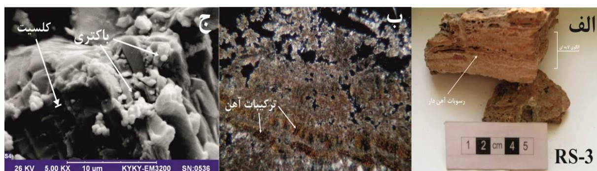
شکل ۶- تصاویر نمونه سنگ RS-3 تهیه شده از چشمه بادآب سورت، الف) الگوی رسوبی لایه‌ای در نمونه دیده می‌شود و همچنین رسوبات آهن دار که به رنگ قرمز دیده می‌شوند، ب) تصویر تهیه شده توسط میکروسکوپ پلاریزان که ترکیبات آهن دار به رنگ قرمز در کنار بلورهای کلسیت به رنگ بژ دیده می‌شوند و ج) تصویر SEM از نمونه سنگی که بلورهای کلسیت دیده شده و همچنین باکتری‌های کوکسی شکل دیده می‌شوند.
