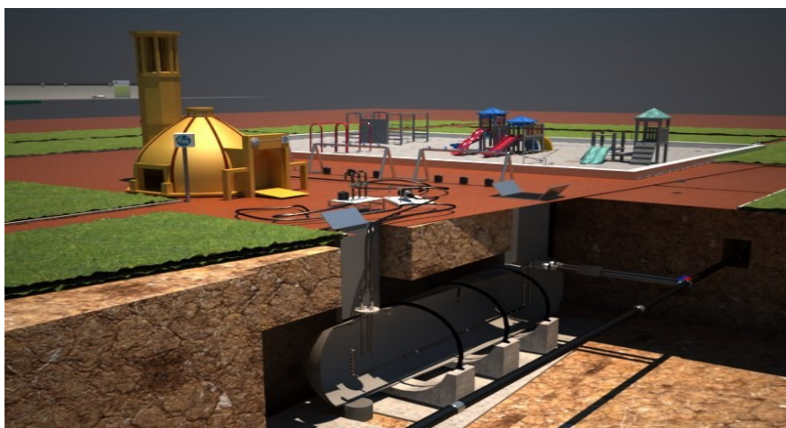
تصویر ۳: نمایشی از طراحی مخازن اضطراری با الهام از آب‌انبارهای قدیمی در محوطه پارک و محل بازی کودکان
