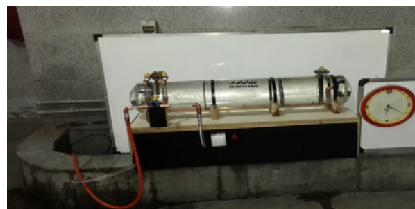
تصویر ۸: نحوه گردش آب در مخزن ساخته شده پایلوت ۲۰ لیتری
