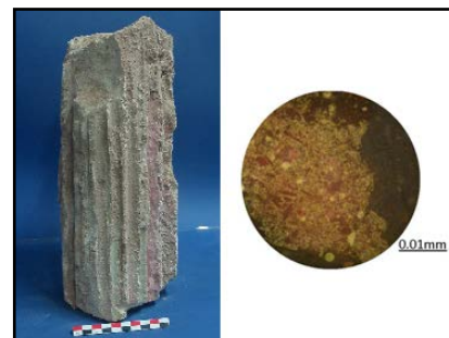
▲ تصویر ۱۰. سمت چپ: نمونه‌ی مورد آزمایش؛ سمت راست: ویژگی میکروسکوپی از رنگ‌دانه‌ی صورتی (نگارندگان، ۱۳۹۴).
