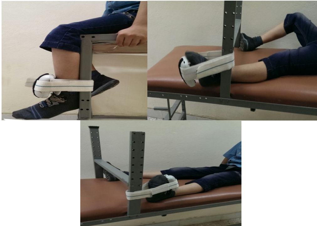
شکل ۲: اندازه‌گیری قدرت عضلات چهارسر ران و دورسی فلکشن و پلانتار فلکشن مچ پا
