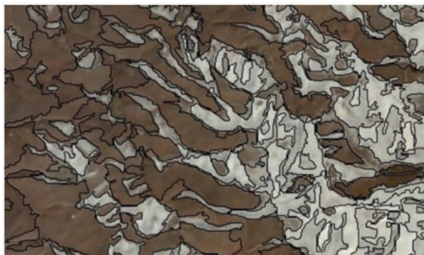
نگاره ۸: قطعه‌بندی با مقیاس ۷۵، ضریب شکل ۰/۶ و ضریب فشردگی ۰/۸
