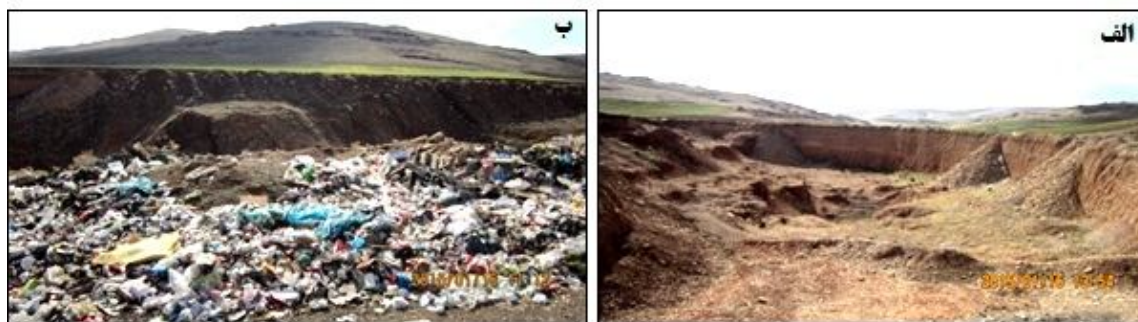
شکل ۸: الف) ایجاد حفره های بزرگ و ب) تبدیل بعضی از آنها به محل تجمع زباله ها در نتیجه بهره برداری از منابع خاکی و شنی در ناحیه معدنی سراب نیلوفر
