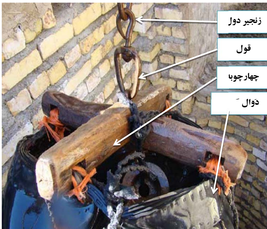
عکس ۹- اجزا و عناصر تشکیل‌دهنده دلو در گاوچاه حاج ابراهیم (ورزنه)
