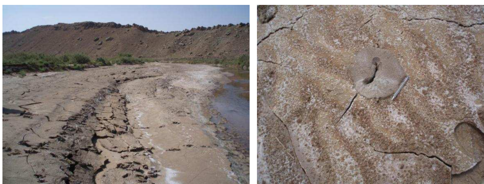
شکل ۹: پدیده روانگرایی و بیرون زدن ماسه از زمین در محدوده روستای مرجانلار (راست)، گسترش جانبی در دشت نوشام در محدوده روستای گمند (چپ) (مهدوی فر و معاریان، ۱۳۹۱)
