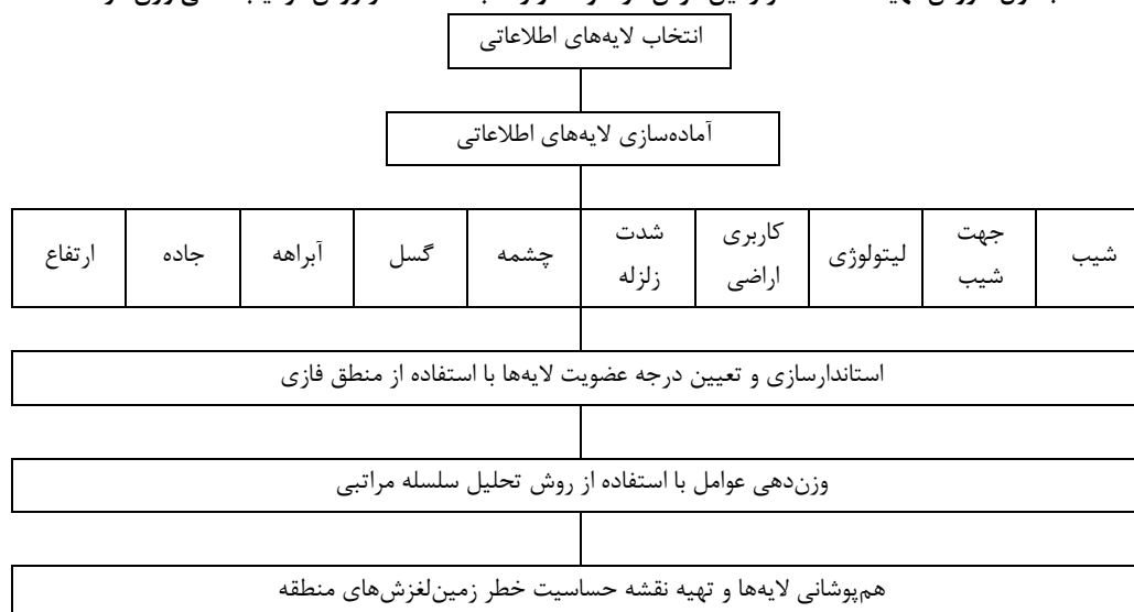
جدول ۱: روش تهیه نقشه خطر زمین‌لغزش در حوضه وارک با استفاده از روش ترکیب خطی وزن‌دار
