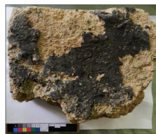
شکل ۲: الف) نمونه آجر دارای ملات قیر که نمونه‌ها از روی آن برداشته شده‌اند (ب) نمونه‌های قیر برداشته شده از روی آجر (یوسف‌نژاد، ۱۳۹۱، ص. ۱۵۴)
