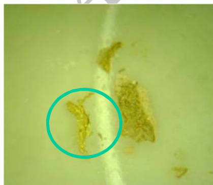
شکل ۷: تصویر میکروسکوپی نمونه‌ی برجای مانده از ورق طلا پس از آزمون کوره (بزرگنمایی ۴۰ برابر)
