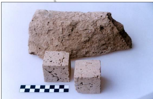
شکل ۷: بررسی وضعیت تخلخل در خشت‌های مورد مطالعه Fig: 7: Investigation of the porosity of the studied adobes
