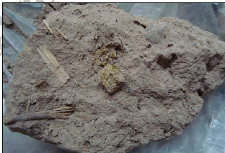
شکل ۴: وجود اجزای زائد (خاشاک و فضولات حیوانی) در نمونه خشت H3. Fig; 4: Brushwood and animal excreta in the adobe sample H3
