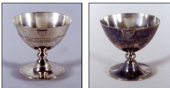
شکل ۴: تصاویری از جام نقره‌ای در قبل و بعد از درمان پلاسما هیدروژن به مدت ۲ ساعت و نیم [34] Fig. 4: Images of Silver chalice before and after 2.5 hours hydrogen plasma reduction [34]
