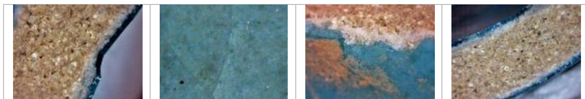
شکل ۲۹. تصاویری با بزرگ‌نمایی ۶۰ برابر از ساختمان لعاب و بدنه قطعه شکسته شده ظرف سفالی در آرایه معماری بنا Fig. 29: Magnified pictures 60 X of Piece of broken glazed Pottery as an architectural decoration
