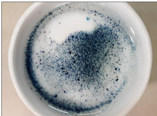
شکل ۷: شناسایی یون آهن (سمت راست: نمونه در اسید کلریدریک، سمت چپ: به دست آمدن رنگ آبی بعد از افزودن فروسیانید پتاسیم) Fig 7: identification of Fe ion (right image: sample in hydrochloric acid, left image: obtaining the blue color after adding Potassium Ferrocyanide)
