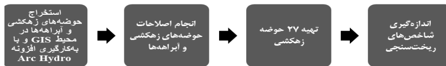
شکل ۴: مراحل تهیه حوضه‌ها و آبراهه‌ها به منظور اندازه‌گیری شاخص‌های ژئومورفولوژی.
