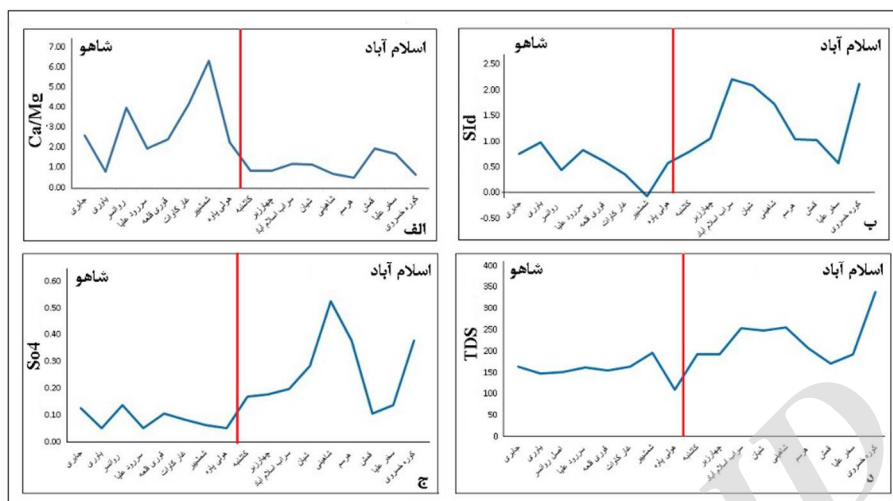
شکل ۳: نمودار الف- نسبت کلسیم به منیزیم در آب چشمه‌ها، ب- شاخص اشباع دولومیت SIa در چشمه‌ها، ج- یون سولفات در محلول در آب چشمه‌ها، د- مقادیر مواد جامد محلول در آب چشمه‌ها
