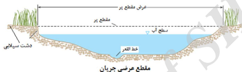
شکل ۲: نمایی از اندازه گیری دبی لبالی (Lawlor, 2004)
