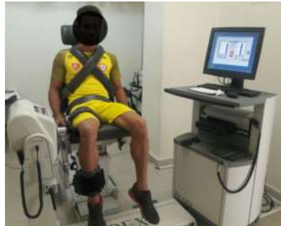
شکل ۱. اندازه‌گیری قدرت ایزومتر و ایزوکنتریک
