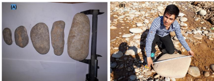
شکل ۱۳. اندازه‌گیری نمونه‌های بزرگ‌تر از ۱۰۰ میلی‌متر با استفاده از کولیس (A). و وجود قلوه‌سنگ‌هایی تا اندازه ۷۰۰ میلی‌متر (B)
