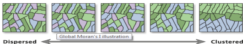
شکل ۲. نمایش سیستماتیک خودهمبستگی فضایی (منبع: ArcGIS10.1)
