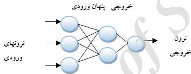
شکل (۳) نمای کلی یک شبکه‌ی عصبی مصنوعی سه لایه
