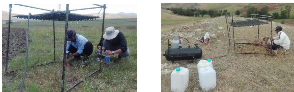
شکل (۲) تصاویری از نحوه برداشت نمونه‌های رواناب و رسوب در عرصه با استفاده از شبیه‌ساز باران Fig (2) Images of field runoff and sediment sampling using rain simulator
