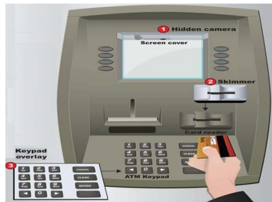
شکل ۱- شمای نصب دوربین در بالای صفحه کلید خودپرداز
